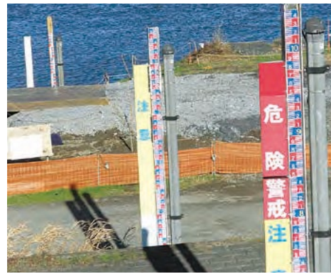
2 利根川にある栗橋水位観測所 氾濫注意水位（5.0m）、避難判断水位（8.0m）、氾濫危険水位（8.5m）とある。栗橋周辺では、たびたび利根川が決壊し、大洪水を発生させている。カスリーン台風時の水位は、9.17mに達した。
